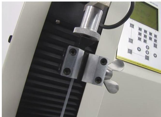
图 7、试样装夹和测试
