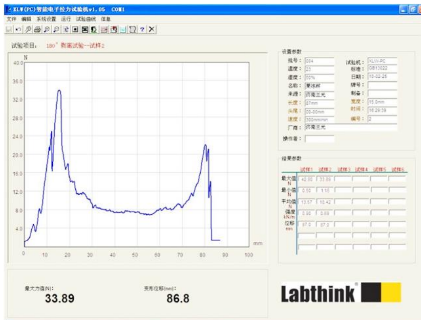
图 6、果冻杯开启力测试曲线图
