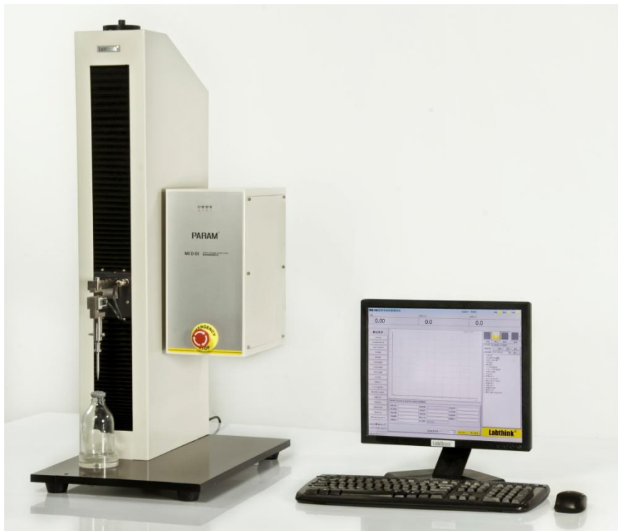
图 2: 医用橡胶塞穿刺力检测
