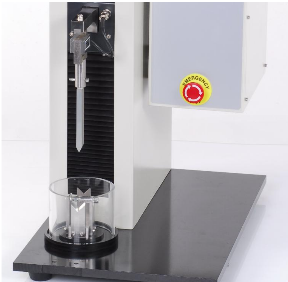
图 8: 安瓿瓶折断力测试
