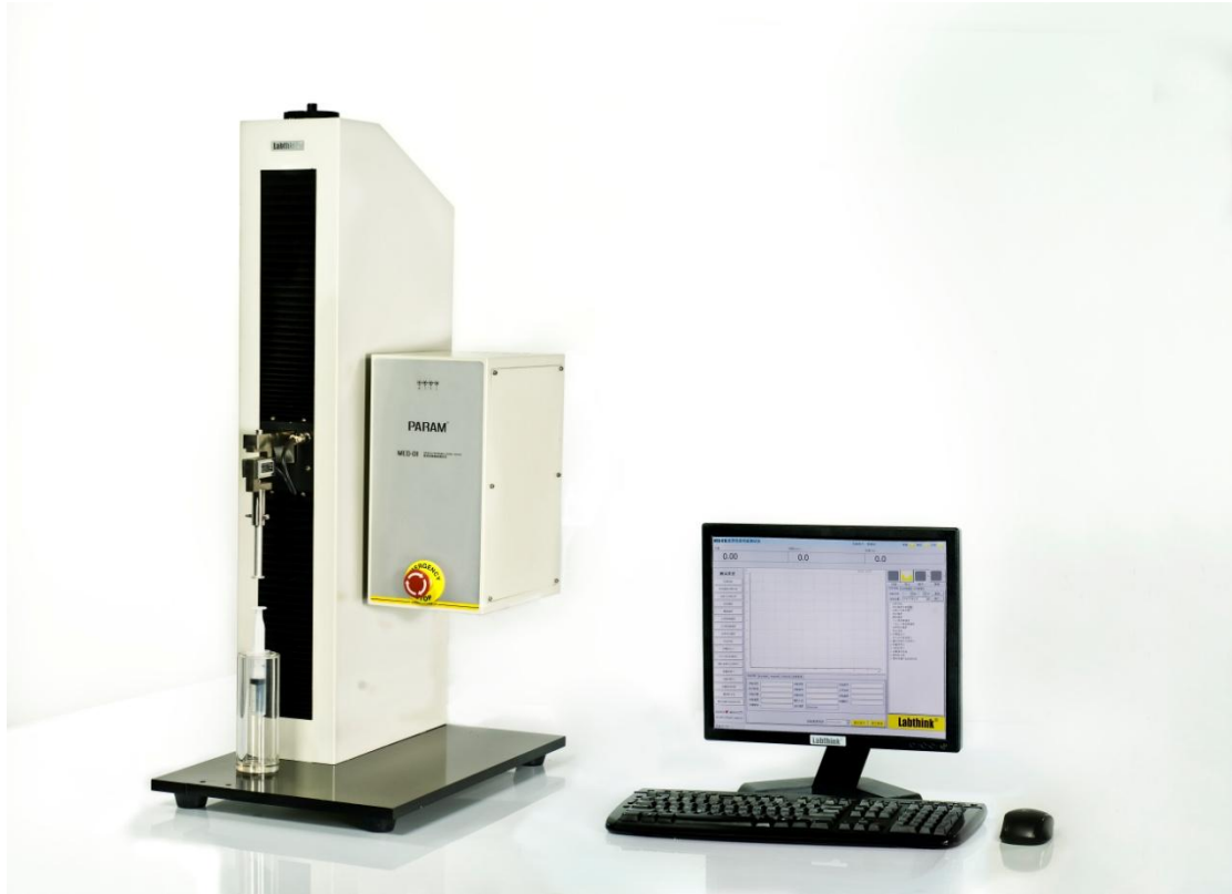
图 7: 预灌封注射器活塞滑动性能测试
