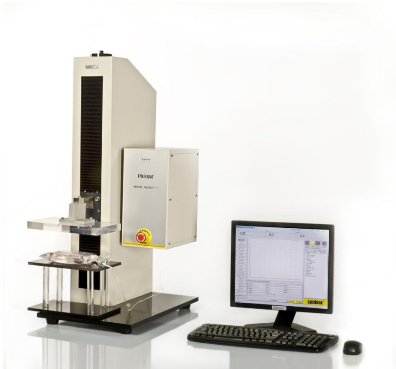
图 4: 医用软塑包装袋外加压密封性测试
